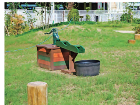
「みんなの森」エリアにはタンク付き手押しポンプが設置されている
